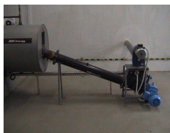
Rys. nr 3 Kocioł z automatycznym podajnikiem paliwa. Rys. nr 4. Podajnik paliwa
